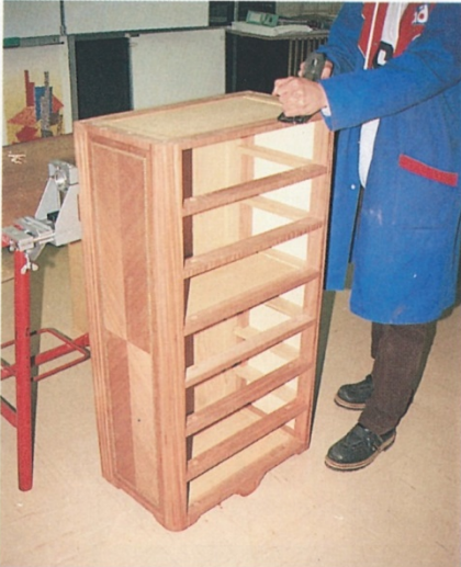
Affleurage du dessus d'un meuble pour la pose d'un marbre. Les cales de protection ne sont pas nécessaires.
