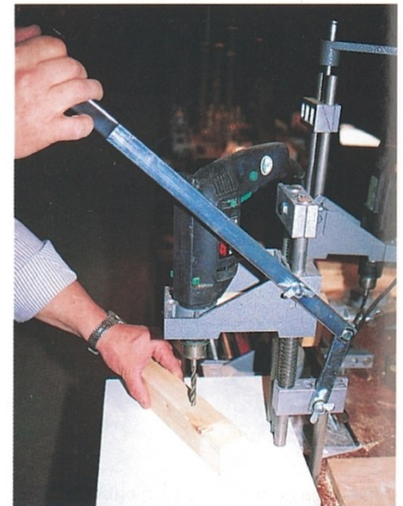
Montage en perceuse à colonne.
