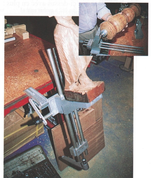
Fixation par une extrémité pour un travail en rond de bosse.
