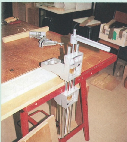
En position verticale, le Multi-service peut devenir un valet d'établi.
