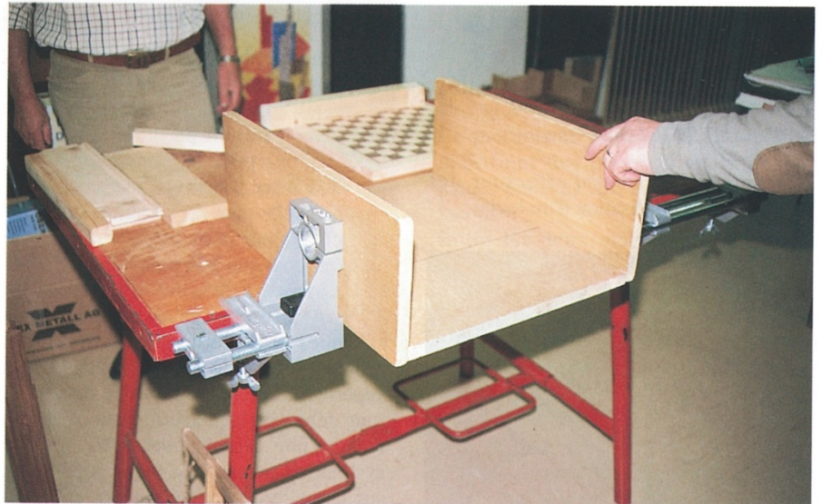
Le Swissrex installé en position haute. Il permet de tenir d'équerre un caisson de tiroir par exemple.
